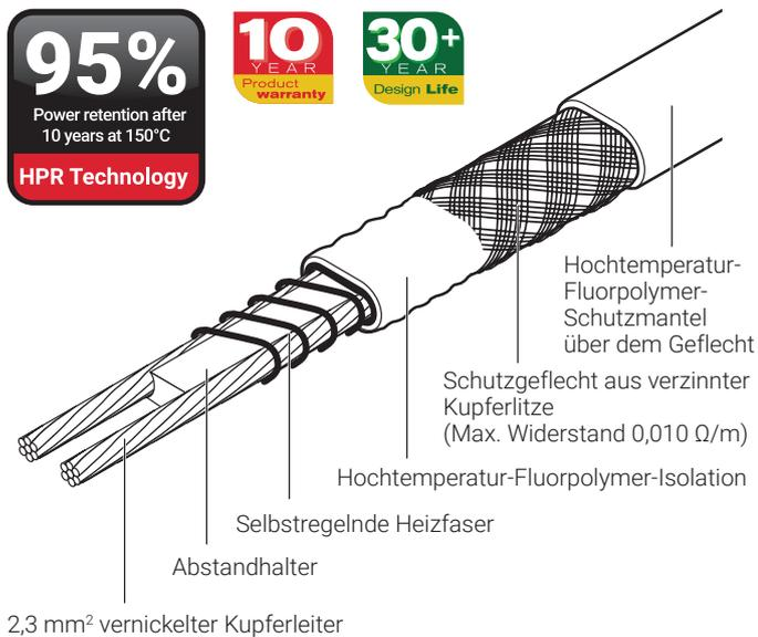
Das selbstregelnde Heizband nVent RAYCHEM XTVR ist für den Frostschutz oder das Halten von Prozesstemperaturen an Aufrechterhaltung von Rohrleitungen und Behältern ausgelegt, die eine hohe Leistungsabgabe und hohe Einsatztemperaturen erfordern.
